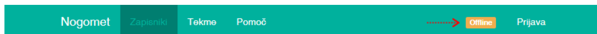
slika6: prikaz indikatorja, ko uporabnik nima aktivne internetne povezave ; uporabnik bo lahko izpolnil zapisnik, a ga ne bo mogel poslati, vse dokler ne vzpostavi aktivno internetno povezavo
